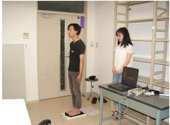
反応時間の測定は、パソコンの画面に文字でランダムに表示されたじゃんけんの手に対し、負ける手の文字が書かれたボタンを押すという方法を用いた。事前に被験者には可能な限り速く、正確にボタンを押してもらうよう要望した。また、手は手首で机に固定してもらった。問題数は計54問で、0～2000msecの間隔を挟んで出題された。文字が表示されてから正しいボタンを押すまでの時間を測定し、不正解の数を数えた。
