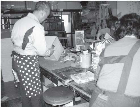
図2 仏壇製造工程のパテ作業
