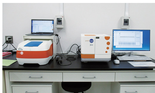
写真左 全自動ELISA装置Ella: 全自動で複数分析物を同時測定できる。90分以内に最大8項目を同時に分析し、データ取得まで行う。 写真右 全自動Western blot装置Jess: サンプル調製以外は全自動で電気泳動からシグナル検出まで行う。高感度で従来の1/5～1/10のサンプル量で分析ができる。
